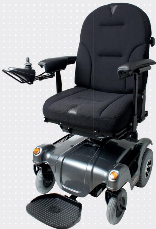
Mit der Möglichkeit des variablen Front- bzw. Heckantriebs ist der Nutzer in der Lage, den Stuhl an den jeweiligen Fahrstiel anzupassen. Innerhalb von Räumlichkeiten empfiehlt sich der Frontantrieb - für eine bessere Richtungsstabilität auf längeren Strecken wiederum der Heckantrieb.
